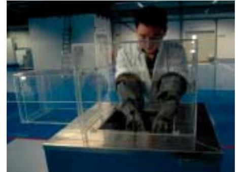
Am IBMT entwickelter Einfrierautomat zum computer-gesteuerten Einfrieren und Auftauen von Proben. Das System ist hochgenau, arbeitet leise und ist auf die Erfordernisse der miniaturisierten Proben optimal angepasst.
