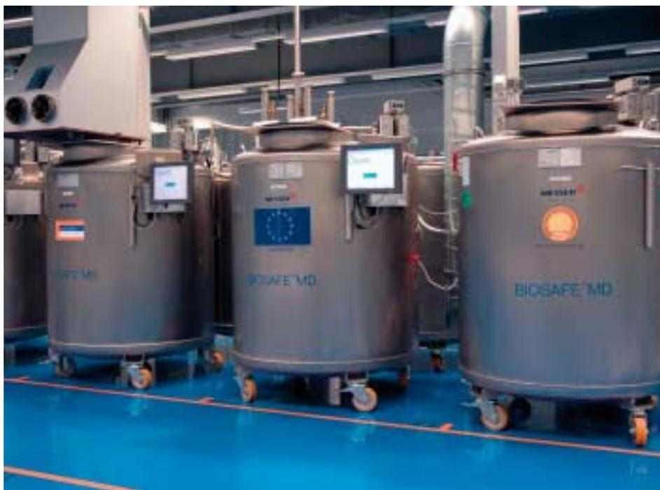
Bereits über Tankspenden finanzierte 1 400 I-Kryotanks in der Kryoforschungsbank in Sulzbach. Auf Basis der neuen Technologie können mehr als 100 000 Lebendproben isolierter Zellen in einem Tank abgelegt werden.
