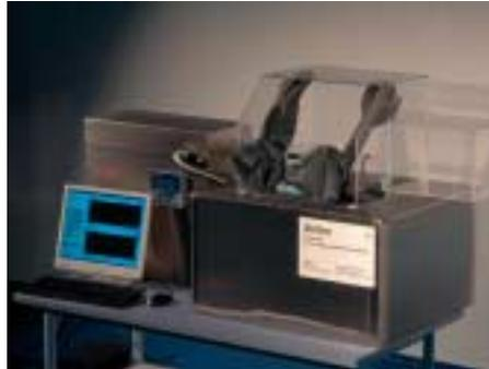
Universelle Haubentechnik zum Arbeiten unter trockener Stickstoffatmosphäre und im Temperaturintervall zwischen -196 °C und +40 °C. Low-Cost-Gefrierautomat.
