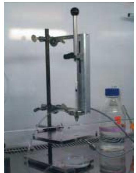
Verkapselungsanlage mit Crystal-Gun für die Alginat-Verkapselung als extrazelluläres Kryoprotektivum.
