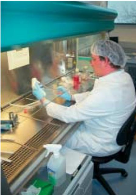
Für die manuelle oder auch automatische Befüllung der Kryolagergefäße stehen Sterilbänke und Prozessautomaten zur Verfügung.
