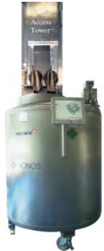
Kryotank der Firma Messer mit Entnahmeturm des Fraunhofer IBMT, der das Vereisen der Proben und des Innenraumes vermeidet und die zur Entnahme ausgewählten Proben über Stunden gekühlt zugriffsbereit hält.
