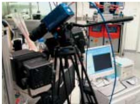
Biomedizinische Ultrahochgeschwindigkeitsfotografie zur Optimierung von Schutzverkapselungen für Zellen für die Kryokonservierung.
