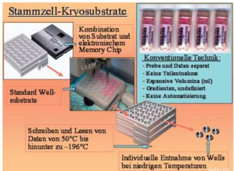
Für die Ablage von Stammzellen und Gewebekörpern geeignete, miniaturisierte Substrate mit elektronischem Speicherchip, denen im tiefgekühlten Zustand einzelne Depots (Wells von einigen µl) entnommen werden können, ohne die Restprobe erwärmen zu müssen. Pro Well lassen sich bis zu 1 Million Zellen unterbringen.
