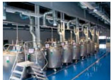
Die Kryolagerbehälter sind in ein vollautomatisches Überwachungs- und Befüllsystem eingebunden. Jeder Kryolagerbehälter ist mit einem Überwachungs-PC ausgestattet.
