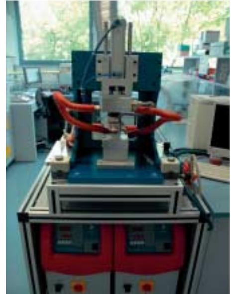
Verschweißgerät für Proben. Das Gerät verschließt die mit einer Folie oder einem Deckel verschlossenen Substrate dauerhaft und robust durch thermisches Verschweißen, ohne die Proben stärker als ein Grad zu erwärmen.
