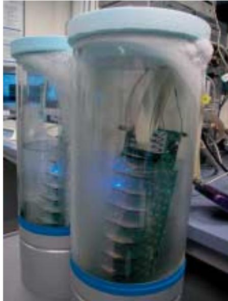
Elektronik zum multiplen Betrieb von tieftemperaturtauglichen elektronischen Speichersystemen. Die Abbildung zeigt einen Zugriff auf Flash-Speicher, die im flüssigen Stickstoff ( $-196\text{ }^{\circ}\text{C}$ ) betrieben werden können. Das IBMT bietet derartige Memory-Chips auch für andere Anwendungen an.
