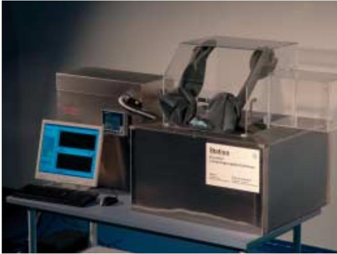
**eurocryo**-Einfrierautomat unter Verwendung der Haubentechnologie zur Vermeidung von Reif- und Oberflächeneisbildung für Temperaturregelungen bis 0,1 °C Genauigkeit.
