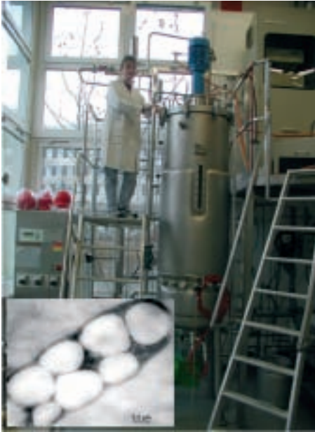
Abb. 2: Bioreaktor (500 L-Fermenter) im Biotechnikum des Instituts für Molekulare Mikrobiologie und Biotechnologie der Universität Münster zur Anzucht von R. eutropha . Insert: Zelle des Stammes H16 mit eingelagerten PHA-Grana (Aufnahme: A. Steinbüchel).
