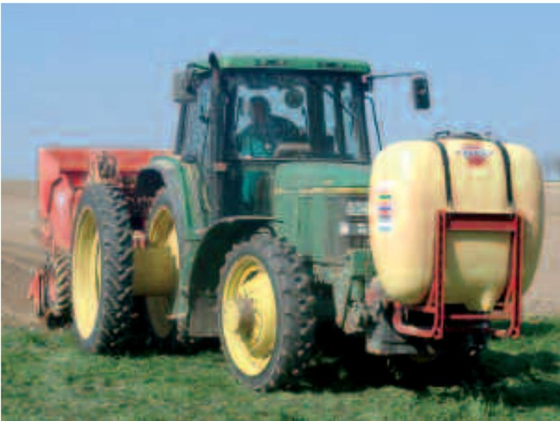
Abb. 1: Kartoffel-Pflanzmaschine mit aufgesatteltem Behälter zur flüssigen Pflanzgutbeizung
