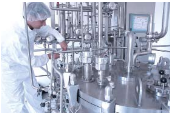
Mehr als 100 in Deutschland verfügbare Medikamente werden biotechnologisch in Fermentern mit Mikroorganismen oder tierischen Zellen hergestellt.
