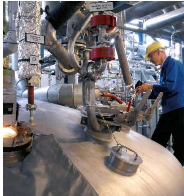
Früher wurden Enzyme aus Schlachttieren gewonnen. Heute stehen Mikroorganismen als Produzenten zur Verfügung, die in Fermentern wie diesen kultiviert werden.
