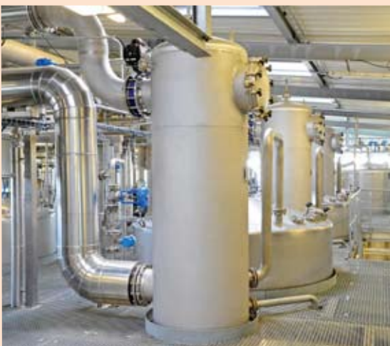
Ein Blick in das Innenleben der Bioraffinerie-Demonstrationsanlage in Straubing. Hier wird Stroh zu Bioethanol umgewandelt.
