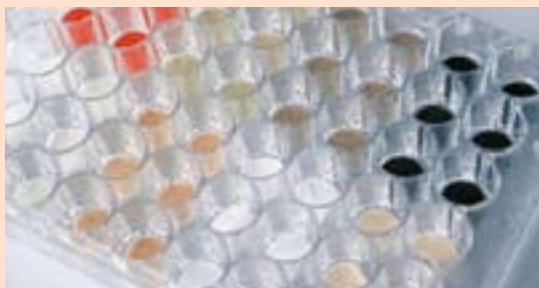
In den Platten befinden sich kleine Lämpchen, die auf unterschiedliche Art schmutzig sind. Damit werden neue Enzyme auf ihre Waschleistung getestet.
