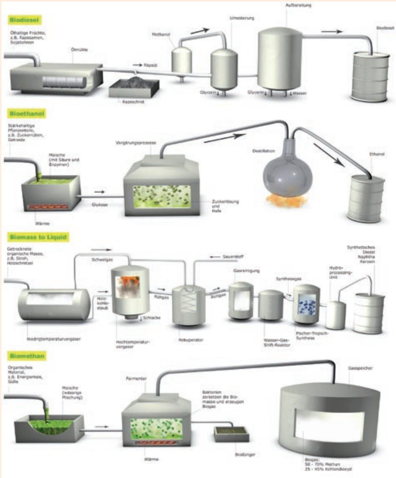
Überblick über die Herstellungswege von Biokraftstoffen: Biodiesel, Bioethanol, Biomass to Liquid und Biogas.
